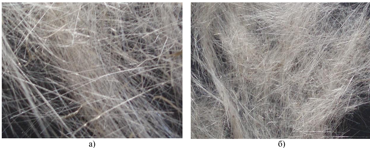
Рисунок 3. Микрофотографии минеральных волокон полученных путем раздува струи расплава имеющей температуру 1700 °С: а — волокна из отходов горючих сланцев ( d=7 мкм), б — волокна из золоотходов ( d=4 мкм). Увеличение \times 300
