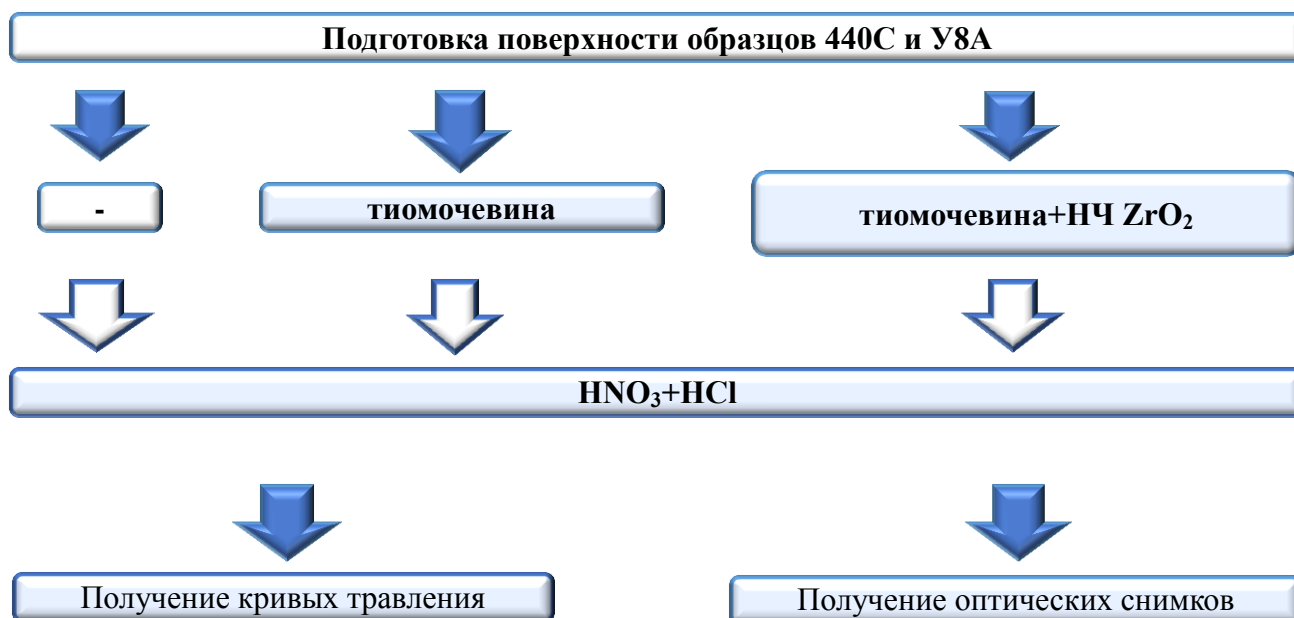
Рисунок 1. Общая схема эксперимента по подбору ингибитора.
