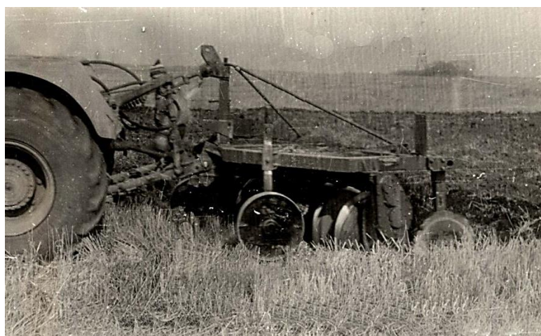
Рисунок 2. Навесной роторный плуг ПРН-2,2 в агрегате с трактором Т-150К.
