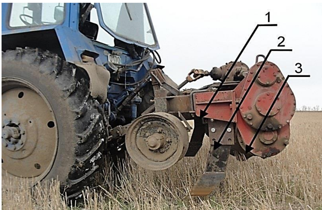
Рисунок 4. Комбинированная почвообрабатывающая машина: 1 — правый почвоуглубитель; 2 — левый почвоуглубитель; 3 — ротор.
