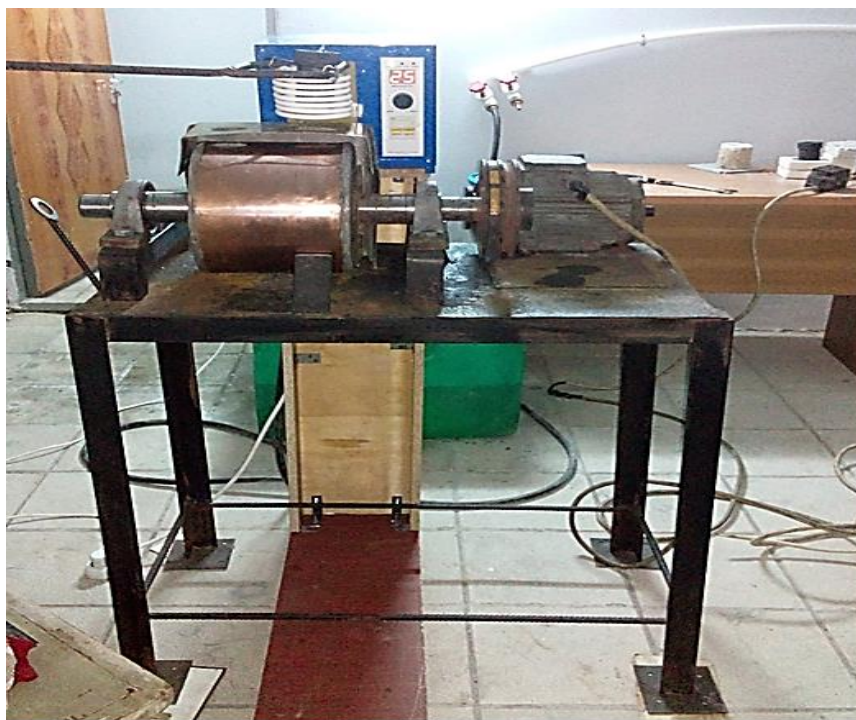
Рисунок 1. Установка для получения лент с аморфной структурой.
