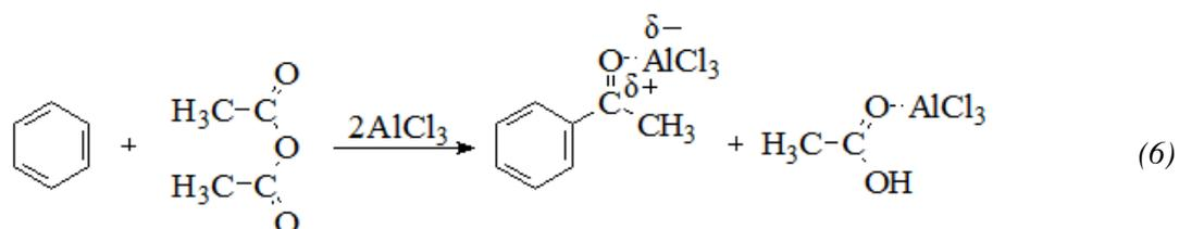
С помощью смешанного ангидрида могут образовываться два различных арилкетона. Реакция циклического ангидрида с ангидридом дикарбоновой кислоты, например, янтарной кислоты, приводит к образованию арилкетокислоты [2]. Карбоновая кислота также может быть непосредственно использована в качестве ацилирующего агента, но в этом случае в качестве катализатора используют протонную кислоту.
